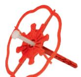
За закрепване при наличие на стари мазилки с макс. 40 mm дебелина, сертифицирано с европейско техническо одобрение (по ETAG 004), като елемент от ИТИС на Баумит. Дълбочина на анкериране в носещата основа:  $\geq 40 \text{ mm}$
