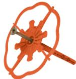
Специално за кухи тухли, газобетон и критични основи. Налични стари мазилки до макс. 40 mm могат да бъдат премоствани. Монтаж: чрез накрайник Bit Torx T30. Дълбочина на анкериране в носещата основа:  $\geq 40 \text{ mm}$ /65 mm в газобетон
